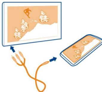
Não ligue produtos que originem um sinal de saída, uma vez que poderá causar danos no dispositivo. Não ligue qualquer fonte de tensão ao conector AV Nokia. Se ligar um dispositivo externo ou auricular diferentes dos aprovados pela Nokia para utilização com este dispositivo, ao conector AV Nokia, preste especial atenção aos níveis do volume.
