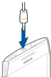
Não ligue produtos que originem um sinal de saída, uma vez que poderá causar danos no dispositivo. Não ligue qualquer fonte de tensão ao conector AV Nokia. Se ligar um dispositivo externo ou auricular diferentes dos aprovados pela Nokia para utilização com este dispositivo, ao conector AV Nokia, preste especial atenção aos níveis do volume.
