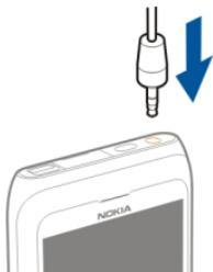
Schließen Sie keine Produkte an, die ein Ausgangssignal erzeugen, da das Gerät dadurch beschädigt werden kann. Schließen Sie keine Spannungsquelle an den Nokia AV-Anschluss an. Achten Sie besonders auf die Einstellung der Lautstärke, wenn Sie ein externes Gerät oder Headset, das nicht von Nokia für die Verwendung mit diesem Gerät zugelassen wurde, an den Nokia AV-Anschluss anschließen.
