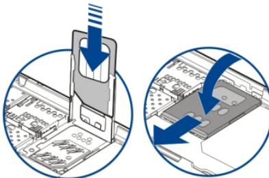
6 按下 SIM 卡夹，将其固定到位。滑动 SIM 卡夹将其锁定。
