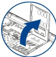
5 确保 SIM 卡的触点朝向设备，将 SIM 卡滑入 SIM 卡夹中。
