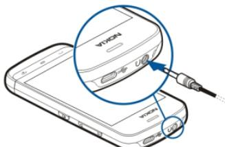
Не подключайте аппаратуру, которая формирует выходной сигнал, поскольку в результате устройство может оказаться повреждено. Не подключайте источники напряжения к разъему Nokia AV. При подключении к разъему Nokia AV внешнего устройства или минигарнитуры, отличных от рекомендованных корпорацией Nokia для данного устройства, уделите особое внимание уровню громкости.
