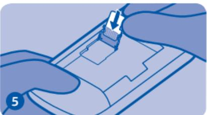
Setzen Sie eine passende Speicherkarte mit der Kontaktfläche nach unten weisend ein.
