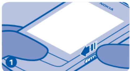
Zum Sperren oder Entsperren schieben Sie den Sperrschalter in die gewünschte Position.
