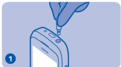
Schließen Sie ein kompatibles Headset an. Das Headset fungiert als Antenne.
