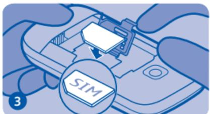
Öffnen Sie den Halter, und setzen Sie die SIM-Karte mit der Kontaktfläche nach unten weisend ein. Siehe 2.
