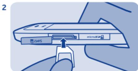
Coloque o chip com a área de contato voltada para cima.
