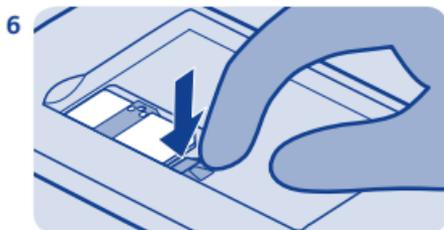
Para remover o chip, pressione a lingueta para baixo e deslize o chip para fora.
