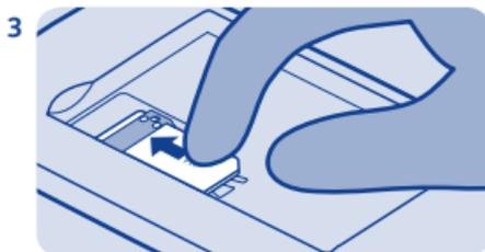
Deslize o chip sob o compartimento com a área de contato voltada para baixo.
