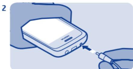
2 将充电器连接线连接到手机。请参见“功能特定说明”中的 2。
