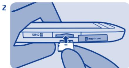
使触点朝上, 然后插入存储卡。
