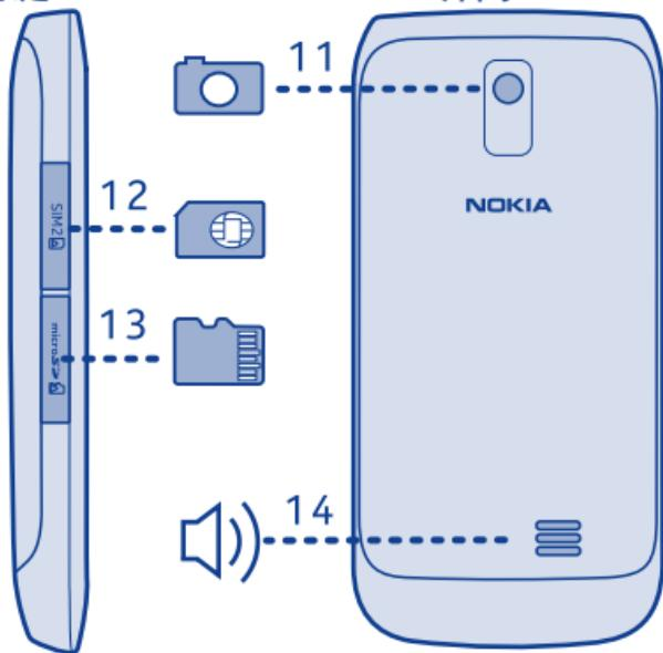
11 照相机镜头。在使用照相机之前, 请从镜头上取下保护性胶带。
