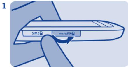
打开存储卡插槽保护盖。
