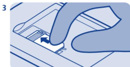
3 使 SIM 卡触点朝下，滑动卡夹下的 SIM 卡。
