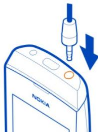
Non collegare prodotti che generano segnali in uscita, in quanto ciò potrebbe danneggiare il dispositivo. Non collegare il Nokia AV Connector ad alcuna fonte di alimentazione. Se si collega un dispositivo esterno o un auricolare, diverso da quello approvato per questo dispositivo, al Nokia AV Connector, prestare particolare attenzione al livello del volume.
