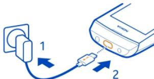
È possibile utilizzare il cavo USB per caricare quando una presa a muro non è disponibile. Mentre il dispositivo è in carica i dati possono essere trasferiti. L'efficacia della carica USB varia in modo significativo; prima di iniziare a caricarsi e a funzionare, il dispositivo potrebbe impiegare diverso tempo.
