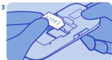
3 Abra o compartimento e coloque o SIM com a área de contato voltada para baixo. Consulte ➔ 3.
