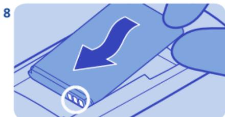
Alinee los contactos de la batería y coloque la batería.
