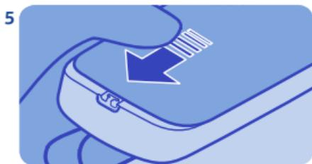
Deslice la tapa posterior hacia abajo hasta que se bloquee en el lugar.
