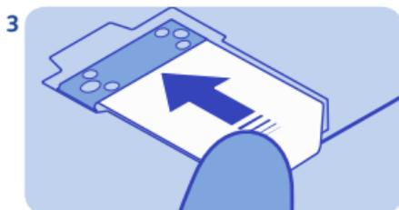
Deslice la SIM en el soporte con el área de contacto hacia abajo. Consulte ➔ 2 en "Instrucciones específicas de las funciones".
