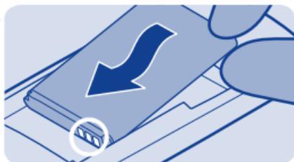
Beachten Sie die Anschlusskontakte des Akkus und setzen Sie den Akku ein.
