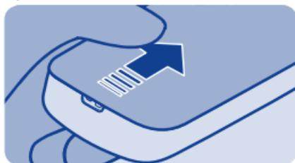
Schalten Sie das Mobiltelefon aus und nehmen Sie die rückseitige Abdeckung ab.
