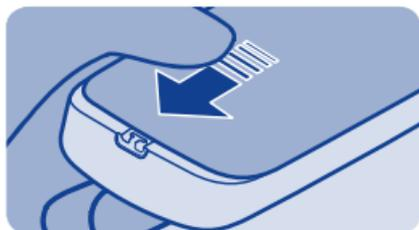
Schieben Sie die rückseitige Abdeckung nach unten, bis sie einrastet.
