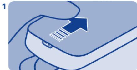
Schalten Sie das Mobiltelefon aus und nehmen Sie die rückseitige Abdeckung ab.
