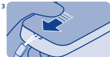
Schieben Sie die rückseitige Abdeckung nach unten, bis sie einrastet.
