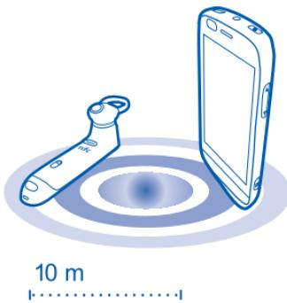
本设备支持蓝牙规范版本 3.0，并支持以下情景模式：免提模式 (1.6)、耳机模式 (1.2)、高级音频传输模式 (1.2) 和音频/视频远程控制模式 (1.4)。请向其他设备的制造商咨询，以确定其设备是否与本设备兼容。
