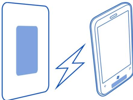
Qi funciona con inducción magnética y está diseñado para dispositivos que usan 5 vatios de potencia o menos, como los teléfonos móviles. Los cargadores y dispositivos Qi usan la misma frecuencia, de modo que mientras que sus áreas activas estén tocándose, todos los dispositivos Qi son compatibles, sin importar el fabricante o la marca. Para obtener detalles, consulte los manuales de usuario de ambos dispositivos.
