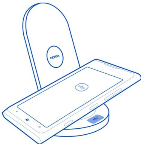
Para comenzar la acción, toque el área NFC del teléfono en el área NFC del cargador.
