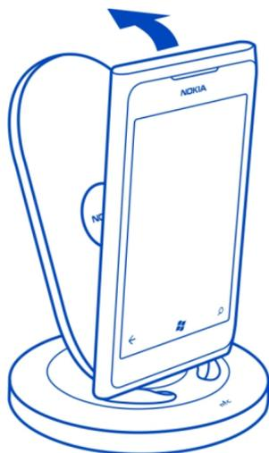
Es normal que el cargador y el teléfono se calienten durante la carga. Si usa el teléfono para transmitir música durante la carga, el calentamiento aumentará.
