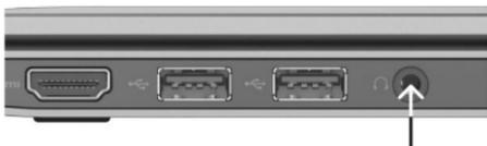
Puede conectar a su dispositivo unos auriculares compatibles que tengan un conector de 3,5 mm.
