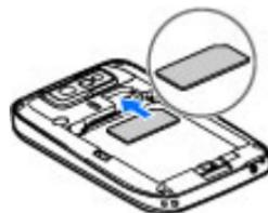
4. Inserte la batería. Alinee los contactos de la batería con los conectores correspondientes del compartimento de la batería e insértelos en el sentido indicado por la flecha.
