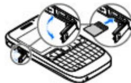
2. Inserte la tarjeta de memoria en la ranura con el área de contacto primero. Asegúrese de que el área de contacto está orientada hacia los conectores en el dispositivo.
