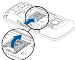
٤ ارفع حامل بطاقة SIM، ثم أدخل بطاقة SIM. تأكد من إمكانية توجيهه منطقة التلامس الموجودة بالبطاقة لأسفل عند إنزال حامل بطاقة SIM.
