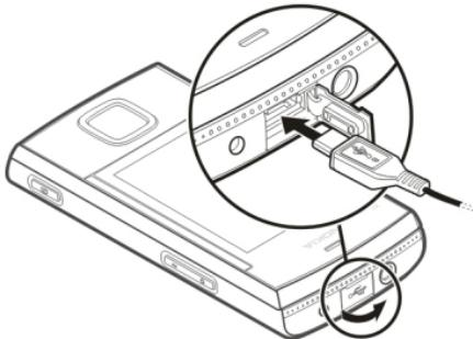
Abra la cubierta del conector USB y conecte el cable USB al dispositivo.
