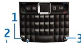
1 — Tecla de función. Para insertar dígitos o caracteres impresos en la parte superior de las teclas, mantenga pulsada la tecla de función y pulse la tecla correspondiente, o mantenga pulsada sólo la tecla correspondiente. Para ingresar sólo los caracteres impresos en la parte superior de las teclas, pulse dos veces la tecla de función con rapidez.
