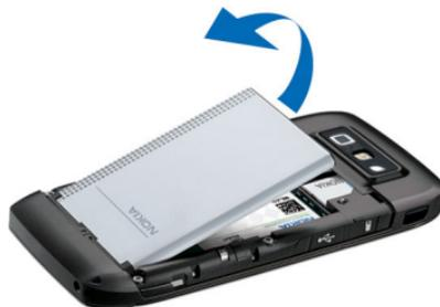
3. Inserte la tarjeta SIM. Asegúrese de que el área de contacto de la tarjeta está orientada hacia los conectores del dispositivo y que la esquina biselada está orientada hacia la parte superior del dispositivo.
