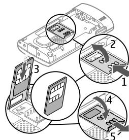
請確認在裝置上卡片的接觸點朝下，並且卡片的斜角在 SIM 卡固定座內是朝下的。
