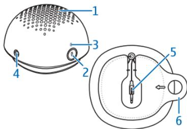
O altifalante contém os seguintes componentes: elemento do altifalante (1), tecla de alimentação (2), luz indicadora (3), conector de áudio de 3,5 mm (4), cabo do altifalante com uma ficha de áudio (5), tampa do compartimento das pilhas e bobina do cabo (6).
