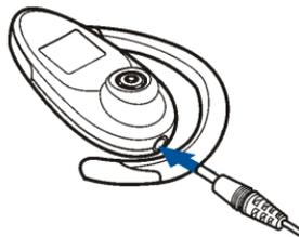
3. Quando la batteria è completamente carica, l'indicatore luminoso rosso si spegne. Scollegare il caricabatterie dall'auricolare e dalla presa a muro o dalla presa di alimentazione del proprio veicolo. Quando si scollega il cavo di alimentazione del caricabatterie, afferrare e tirare la spina e non il cavo.
