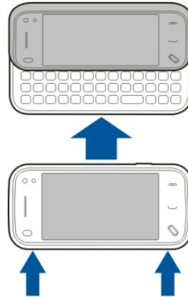
جهازك مزود بلوحة مفاتيح كاملة. لفتح لوحة المفاتيح، اضغط على الشاشة اللمسية لأعلى. في جميع التطبيقات، تستدير الشاشة آلياً من الوضع الرأسي إلى الوضع الأفقي عندما تقوم بفتح لوحة المفاتيح.
