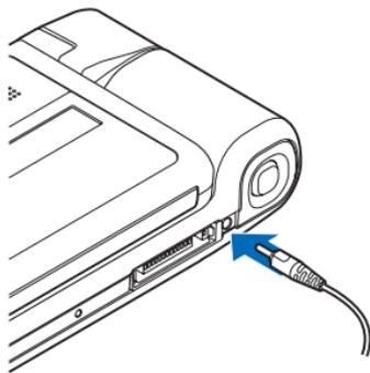
También puede utilizar el Adaptador para cargador de Nokia (CA-44) para cargar la batería con modelos de cargadores antiguos compatibles de Nokia. Para obtener información sobre accesorios, baterías y cargadores, consulte la Guía del usuario, 'Equipamiento, baterías y cargadores' en la página 10.
