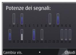
Inizialmente, per poter calcolare le coordinate del punto in cui ci si trova, il dispositivo deve ricevere segnali da almeno quattro satelliti. Effettuato il calcolo iniziale, il dispositivo potrà continuare a calcolare le
