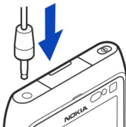
Не подключайте аппаратуру, которая формирует выходной сигнал, поскольку в результате устройство может оказаться повреждено. Не подключайте источники напряжения к разъему Nokia AV. При подключении к разъему Nokia AV внешнего устройства или минигарнитуры, отличных от рекомендованных корпорацией Nokia для данного устройства, уделите особое внимание уровню громкости.
