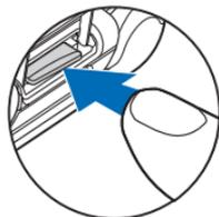
**⚠ Importante:** No extraiga la tarjeta de memoria en medio de una operación cuando se esté accediendo a la tarjeta. La extracción de la tarjeta en medio de una operación puede dañar la tarjeta de memoria y el dispositivo, además de los datos almacenados en la tarjeta.
