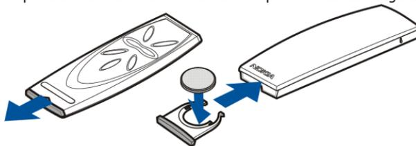
O controlo remoto do Nokia Image Viewer utiliza a pilha de botão do controlo remoto CR2032 fornecida como fonte de energia. Se a pilha do controlo
