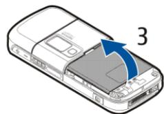
3. Para abrir el compartimento de la tarjeta SIM, tire con cuidado de la pestaña de bloqueo del compartimento de la tarjeta y ábralo (4). Inserte la tarjeta SIM en su compartimento (5). Asegúrese de que la tarjeta SIM se ha insertado correctamente y de que la zona de los contactos dorados se encuentra hacia abajo.
