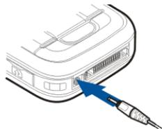
El tiempo de carga depende de la batería y del cargador que se utilice. Por ejemplo, la carga de una batería de ión de litio BP-6M con el cargador AC-4 tarda una hora y 55 minutos aproximadamente mientras el teléfono está en modo de espera.
