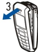
3. Instale a capa do teclado na nova tampa frontal (4).
