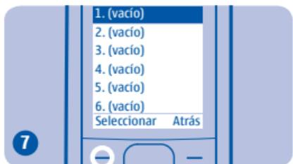
Seleccione un canal vacío. Para guardar más canales, repita los pasos del 3 al 7.
