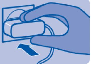
Conecte el cargador a una toma de corriente.
