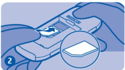
Deslice la tarjeta SIM hacia debajo de la pieza metálica.
