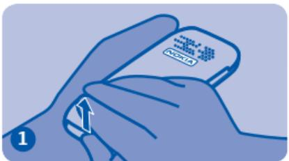
Coloque su dedo en el hueco y levante la cubierta posterior.
