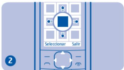
Para dirigirse a una función, pulse la tecla de desplazamiento hacia arriba, abajo, izquierda o derecha.
