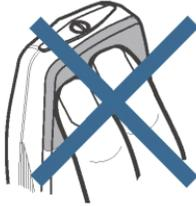
**نصائح حول التشغيل الفعال:** للهاتف هوائي داخلي. كما في أي جهاز إرسال آخر، لا تلمس الهوائي بلا سبب إذا كان الهاتف في وضع الاستخدام. التماس مع الهوائي يؤثر على جودة المكالمات وقد يؤدي إلى استهلاك الهاتف لطاقة أكثر مما يجب. عدم لمس الهوائي أثناء عمل الهاتف يؤدي إلى أداء أفضل للهوائي ولمدة خُدت أطول.
