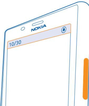
音量鍵可以控制所有音效，包括鬧鐘和提醒的音量。
