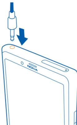
請勿連接會產生輸出訊號的產品，以免造成裝置損壞。請勿在音訊插孔連接任何電源。如果您將未經 Nokia 認證可搭配本裝置使用的任何外部裝置或耳機連接至音訊插孔，請特別留意音量。
