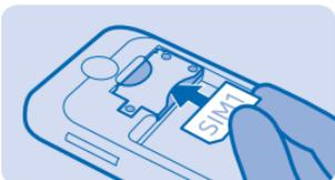
4. 要插入第二張 SIM 卡，將 SIM 卡接觸點朝下推入，直到其鎖定位。
