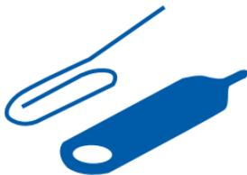
1. 將退卡針推入洞中，直到卡夾鬆開為止，然後將卡夾往外拉出。
