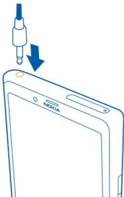
請勿連接會產生輸出訊號的產品，以免造成裝置損壞。請勿在音效插孔連接任何電源。如果連接任何非經認可用於搭配本裝置的外部裝置或耳機至音效插孔，請特別注意音量級別。
