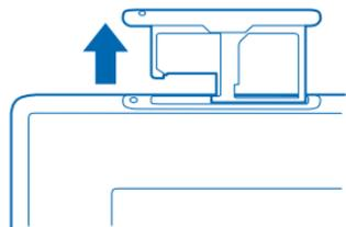
3. Coloque os cartões no compartimento com as áreas de contato voltadas para baixo, o cartão de memória à esquerda e o SIM à direita, e empurre o compartimento de volta no tablet.
