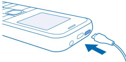
Se la batteria è completamente scarica, potrebbero passare alcuni minuti prima che l'indicatore di carica appaia sul display.
