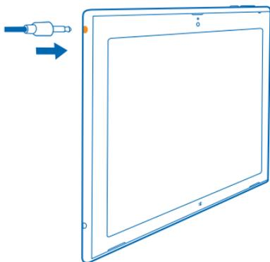
Non collegare prodotti che generano segnali in uscita, in quanto ciò potrebbe danneggiare il dispositivo. Non collegare il connettore audio ad alcuna fonte di alimentazione. Se si collega un dispositivo esterno o un auricolare, diverso da quello approvato da Nokia per questo dispositivo, al connettore audio Nokia, prestare particolare attenzione al livello del volume.
