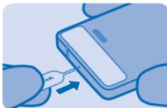
2. Spingere la SIM verso l'interno, con la superficie dell'area di contatto rivolta verso il basso, fino a bloccarla in posizione. Lo slot della SIM2 può essere utilizzato solo per le SIM 2G.
