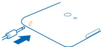
Jangan sambungkan ke produk yang menghasilkan sinyal output karena dapat merusak perangkat. Jangan sambungkan sumber tegangan ke soket audio. Jika Anda menyambungkan perangkat eksternal atau headset selain yang disetujui untuk digunakan dengan perangkat ini ke soket audio, perhatikan tingkat volume suara secara khusus.
