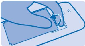
**3.** Deslice la SIM en el compartimento, con el área de contacto orientada hacia abajo.
