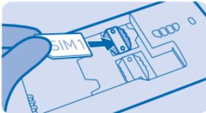
**4.** Para insertar una segunda SIM, deslice la SIM hacia adentro con la zona de contacto orientada hacia abajo.
