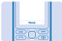
2. Para dirigirse a una aplicación o función, pulse la tecla de desplazamiento hacia arriba, hacia abajo, hacia la izquierda o hacia la derecha.
