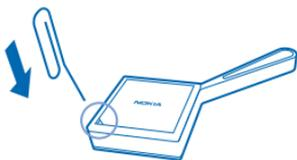
2. Haga palanca suavemente para levantar la tapa posterior.
