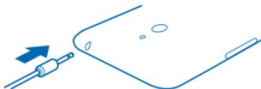
No conecte productos que emitan una señal de salida, porque puede dañar el dispositivo. No conecte ninguna fuente de voltaje al conector de audio. Si conecta un conector de AV a algún dispositivo externo o auricular que no sean los aprobados para este dispositivo, preste especial atención a los niveles de volumen.
