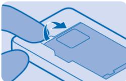
3. Levante el soporte de la SIM e introduzca la tarjeta con el área de contacto hacia abajo.
