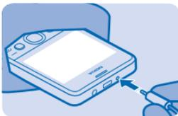
★ **Sugerencia:** Puede cargar el dispositivo a través de USB cuando no esté disponible un tomacorriente. Se pueden transferir datos mientras se carga el dispositivo. La eficiencia de la alimentación a través de USB varía significativamente y puede tardar bastante tiempo para que se inicie la carga y para que el dispositivo comience a funcionar.
