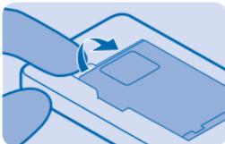
3. Deslice el soporte de la tarjeta de memoria hacia la parte superior del teléfono.
