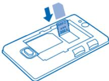
4. Beachten Sie die Anschlusskontakte des Akkus und setzen Sie den Akku ein.
