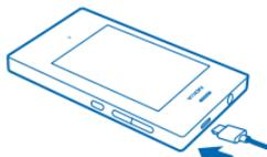
Ist der Akku vollständig entladen, dauert es möglicherweise einige Minuten, bis die Ladeanzeige im Display angezeigt wird oder bevor Anrufe getätigt werden können.
