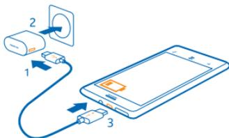
2. Ist der Akku vollständig aufgeladen, trennen Sie das Ladegerät erst vom Telefon und dann von der Steckdose.
