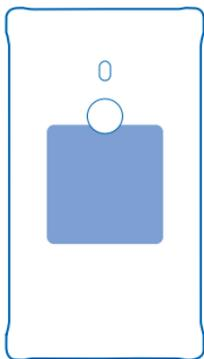
**⚠️ Warnung:** Vergewissern Sie sich, dass sich zwischen Ladegerät und Mobiltelefon keine Gegenstände befinden. Bringen Sie keine Objekte wie Aufkleber an der Geräteoberfläche in der Nähe des Ladebereichs an.
