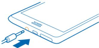
Schließen Sie keine Produkte an, die ein Ausgangssignal erzeugen, da das Gerät dadurch beschädigt werden kann. Schließen Sie keine Spannungsquelle an den Audioanschluss an. Achten Sie besonders auf die Einstellung der Lautstärke, wenn Sie ein externes Gerät oder Headset, das nicht für die Verwendung mit diesem Gerät zugelassen wurde, an den Audioanschluss anschließen.
