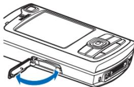
2 Insira o cartão de memória no compartimento. Certifique-se de que a área de contato no cartão esteja voltada para cima e em direção ao compartimento, com o canto recortado voltado para a base do aparelho.
