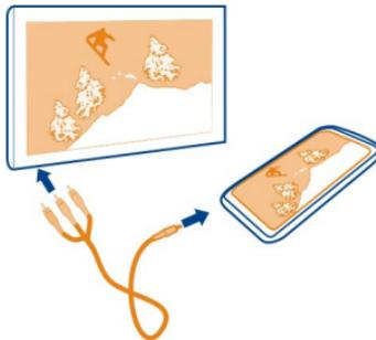
Não conecte produtos que geram um sinal de saída, pois isso pode danificar o dispositivo. Não conecte qualquer fonte de energia com o conector Nokia AV. Se você conectar um dispositivo externo ou fone de ouvido, exceto aqueles aprovados pela Nokia para uso com este dispositivo, com o conector Nokia AV, preste atenção especial aos níveis de volume.
