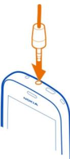
No cone<sup>c</sup>te productos que emitan una se<sup>n</sup>al de salida, porque puede da<sup>r</sup> el dispositivo. No cone<sup>c</sup>te ninguna fuente de voltaje al conector Nokia AV. Cuando cone<sup>c</sup>te al Conector Nokia AV alg<sup>ún</sup> dispositivo externo o auricular que no sean los aprobados por Nokia para este dispositivo, preste especial atenci<sup>o</sup>n a los niveles de volumen.
