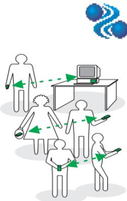
Puesto que los dispositivos Bluetooth usan radioondas, no es necesario alinear su teléfono con el otro dispositivo Bluetooth.
